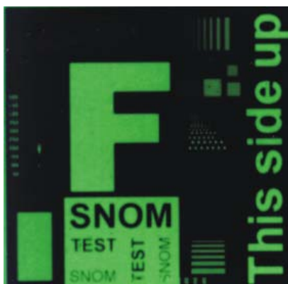
Rys. 9.3. Struktury wzorcowe do obserwacji sił tarcia – obraz obserwowany za pomocą mikroskopu optycznego (wielkość próbki 5×5 mm) [279]
